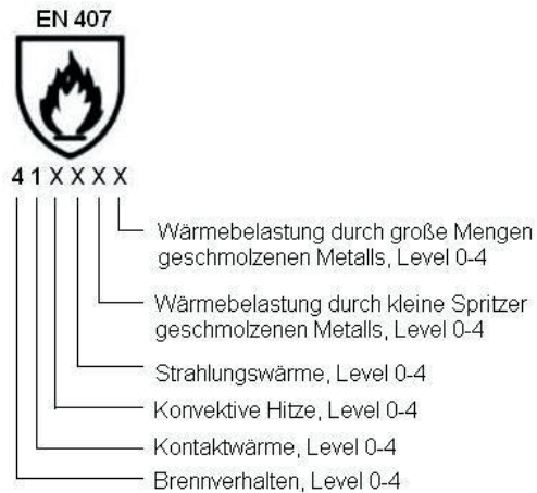
Abb. 2: Beispiel für die Kennzeichnung von Hitzeschutzhandschuhen nach EN 407.
