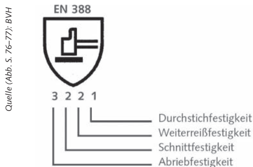
Abb. 1: Beispiel zur Kennzeichnung eines Schutzhandschuhs gegen mechanische Risiken.
